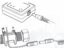
將USB電源線的圓型端子接頭連接至控制盒對應的插槽。
